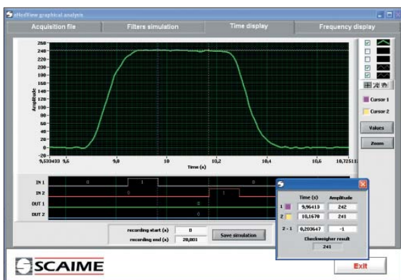
Visualisation du cycle de pesage dynamique avec le logiciel eNodeView Display of checkweighing cycle with eNodeView software
